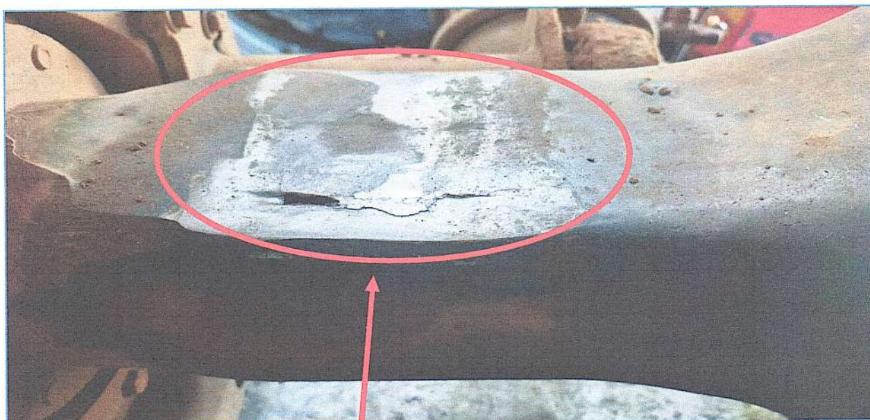
IMAGEM COM EVIDÊNCIA DE FADIGA DE MATERIAL COM TRINCA EXPOSTA E DESGASTE ESTRUTURAL, INVIABILIZANDO O USO SEGURO DO COMPONENTE.
