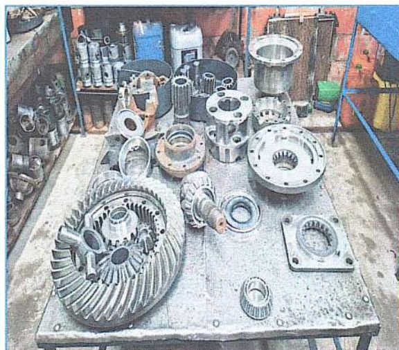
IMAGEM DOS INTERNOS DO CONJUNTO DE DIFERENCIAL DESMONTADOS PARA INSPEÇÃO
