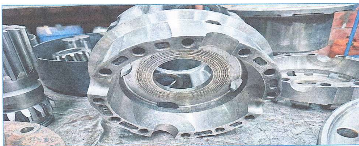
IMAGEM DETALHADA DE COMPONENTE INTERNO DO CONJUNTO DIFERENCIAL ONDE PODEMOS VER CLARAMENTE DESGASTE E AVARIAS ESTRUTURAIS
