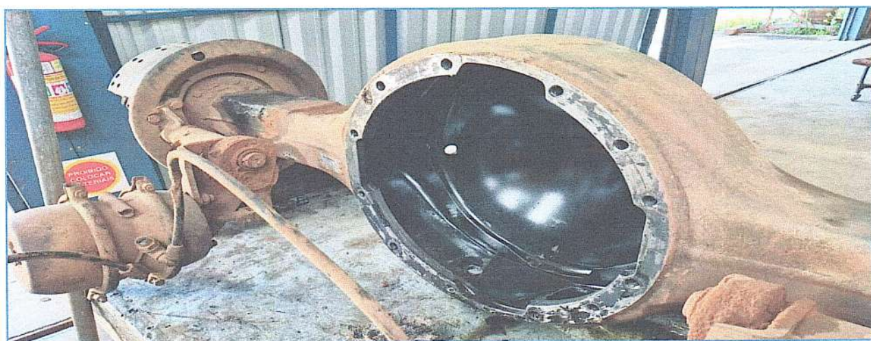
IMAGEM DETALHADA DA CARÇA DO DIFERENCIAL JÁ ABERTA
