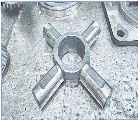
IMAGENS DETALHADAS DE COMPONENTES INTERNOS DO CONJUNTO DIFERENCIAL ONDE PODEMOS VER CLARAMENTE DESGASTE E AVARIAS ESTRUTURAIS
