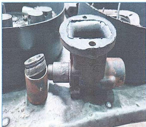
IMAGEM DO PISTÃO DA REDUZIDA DESMONTADO PARA INSPEÇÃO
