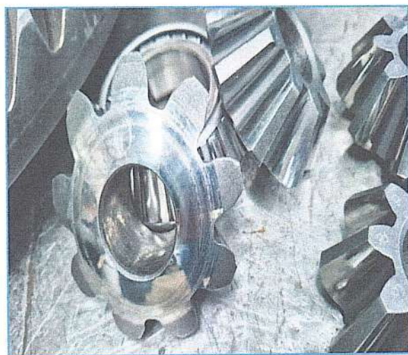
IMAGENS DETALHADAS DE COMPONENTES INTERNOS DO CONJUNTO DIFERENCIAL ONDE PODEMOS VER CLARAMENTE DESGASTE E AVARIAS ESTRUTURAIS
