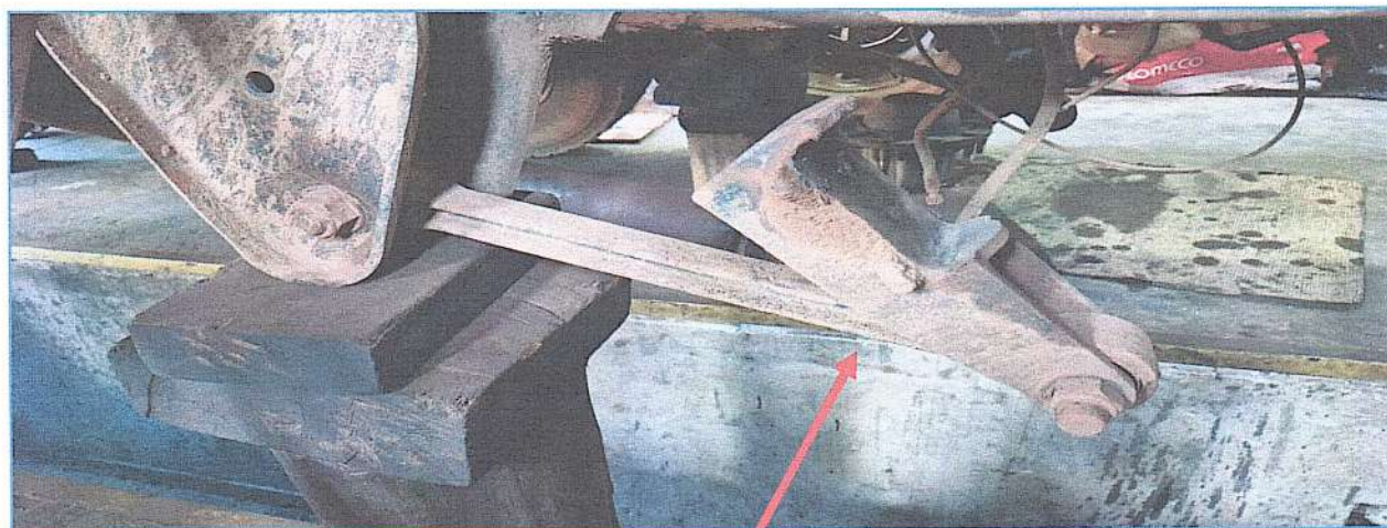
IMAGENS COM DETALHES DA DESMONTAGEM DOS BRAÇOS TENSORES E SUPORTES DA SUSPENSÃO DO IVECO EUROCARGO 230E24 PARA INSPEÇÃO DE DESGASTE E INTEGRIDADE ESTRUTURAL.
