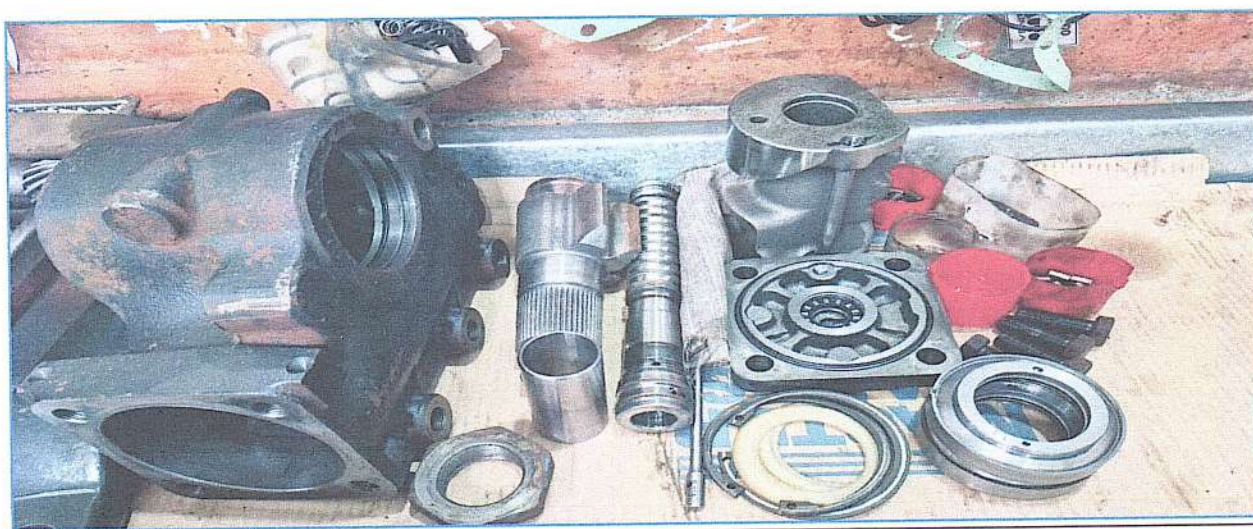
IMAGEM DO SETOR DE DIREÇÃO JÁ DESMONTADO PARA INSPEÇÃO
