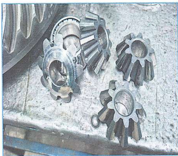
IMAGENS DETALHADAS DE COMPONENTES INTERNOS DO CONJUNTO DIFERENCIAL ONDE PODEMOS VER CLARAMENTE DESGASTE E AVARIAS ESTRUTURAIS
