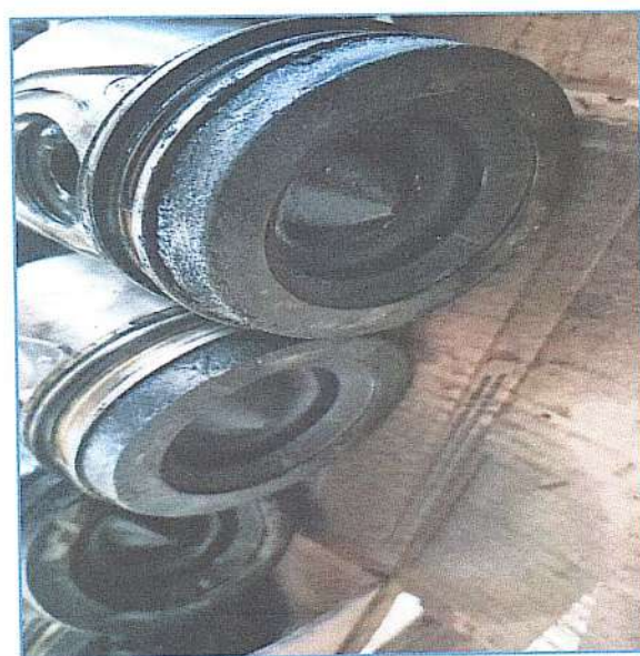
IMAGENS DETALHADAS DE PISTÕES DO MOTOR, SINAIS DE CARBONIZAÇÃO APARENTE
