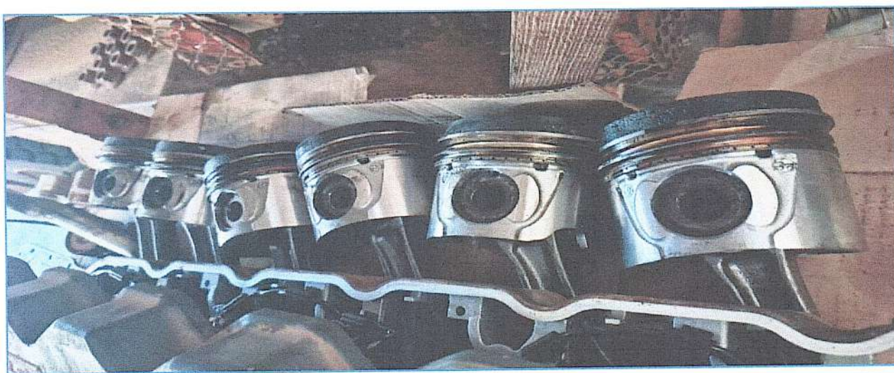
IMAGEM DOS PISTÕES DO MOTOR JÁ DESMONTADOS
