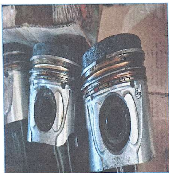
IMAGENS DETALHADAS DE PISTÕES DO MOTOR, SINAIS DE CARBONIZAÇÃO APARENTE
