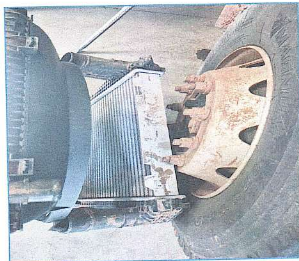
IMAGENS DETALHADAS DO CONJUNTO DE ARREFECIMENTO DO MOTOR, NECESSÁRIO REPAROS
