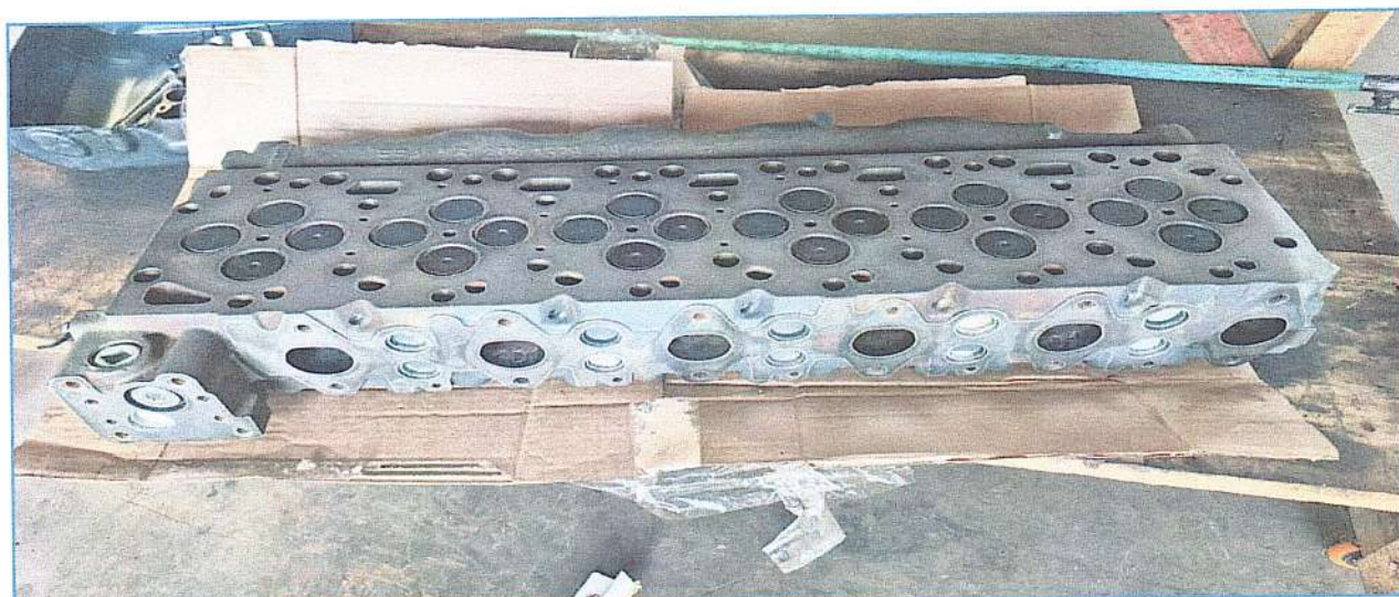
IMAGEM DO CABEÇOTE DO MOTOR DO CAMINHÃO, ELE NÃO APRESENTA PROBLEMAS
