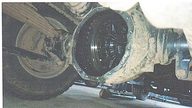
Vista geral do conjunto diferencial dianteiro do tandem parcialmente desmontado
