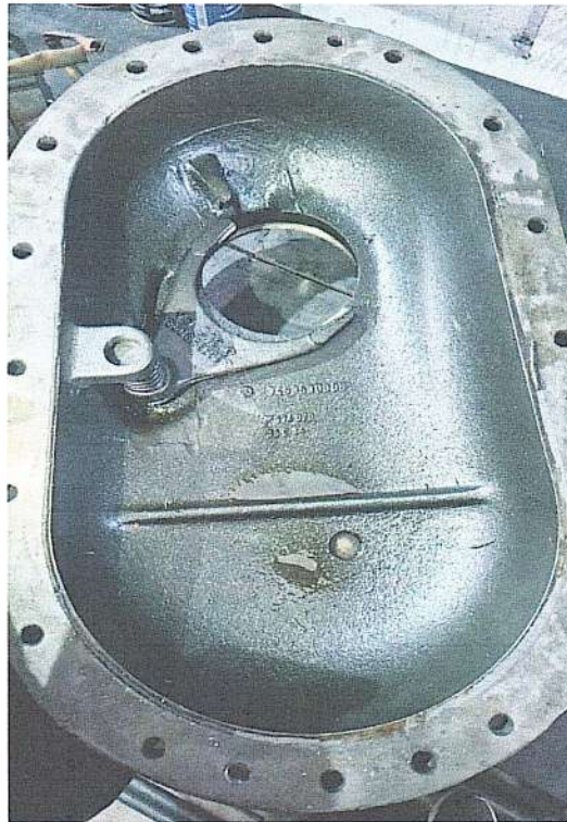
Tampa dianteira do diferencial removida, evidenciando o desgaste do garfo de mudança de bloqueio
