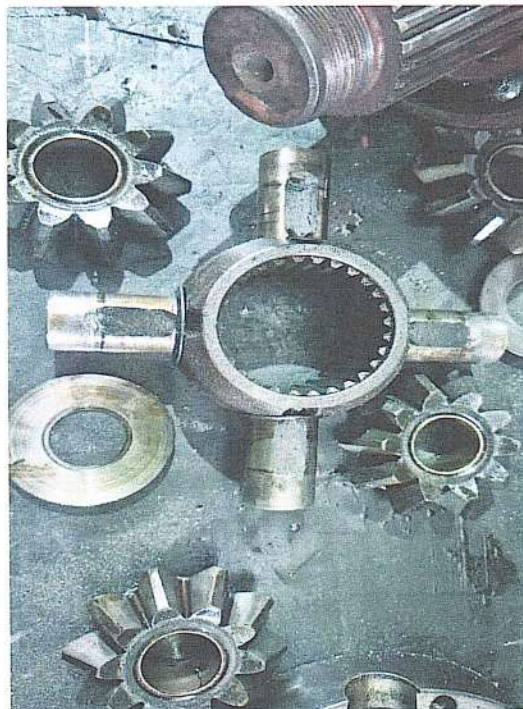
Componentes internos do diferencial (satélites, planetárias e buchas) dispostos para inspeção, com desgaste evidente
