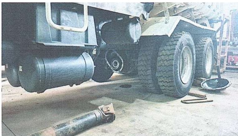
Eixo cardan divisor (inter-axle) e tampa traseira do diferencial desacoplados e dispostos no chão
