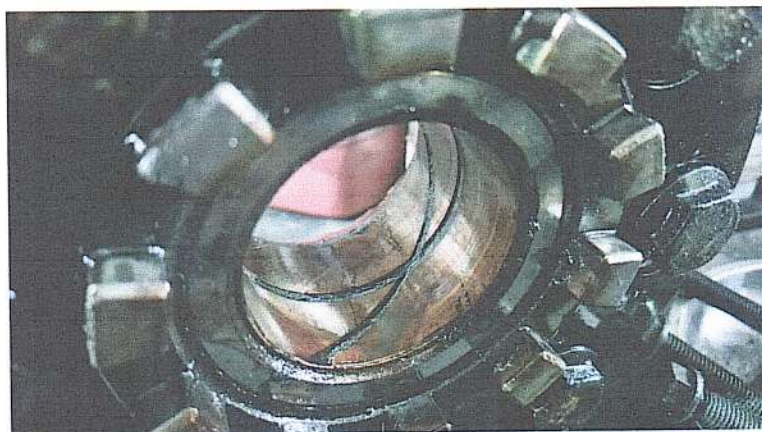
Detalhe de rolamento/bucha do conjunto, apresentando fissura e desgaste acentuado do material
