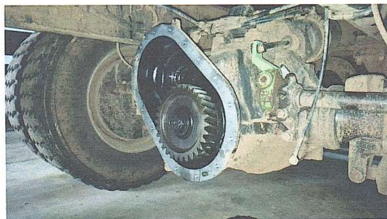
Vista geral do conjunto diferencial dianteiro do tandem desmontado, com o mecanismo de acionamento do bloqueio diferencial aparente
